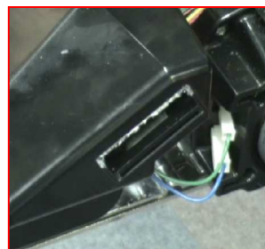
ゴト行為により破損された払出口
