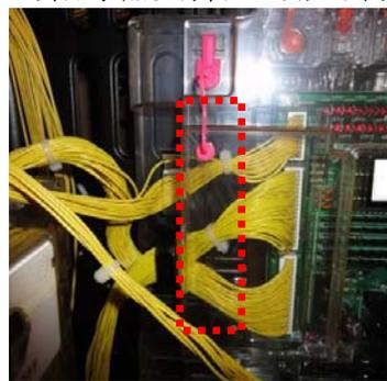
**対策効果** 通信線コネクタ部への接触経路を遮断します。
