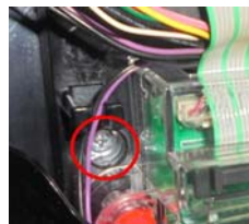
ビス穴を塞ぎ、穴開けによる改造行為を防止します。
