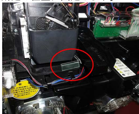
下皿からの挿入経路を遮断します
